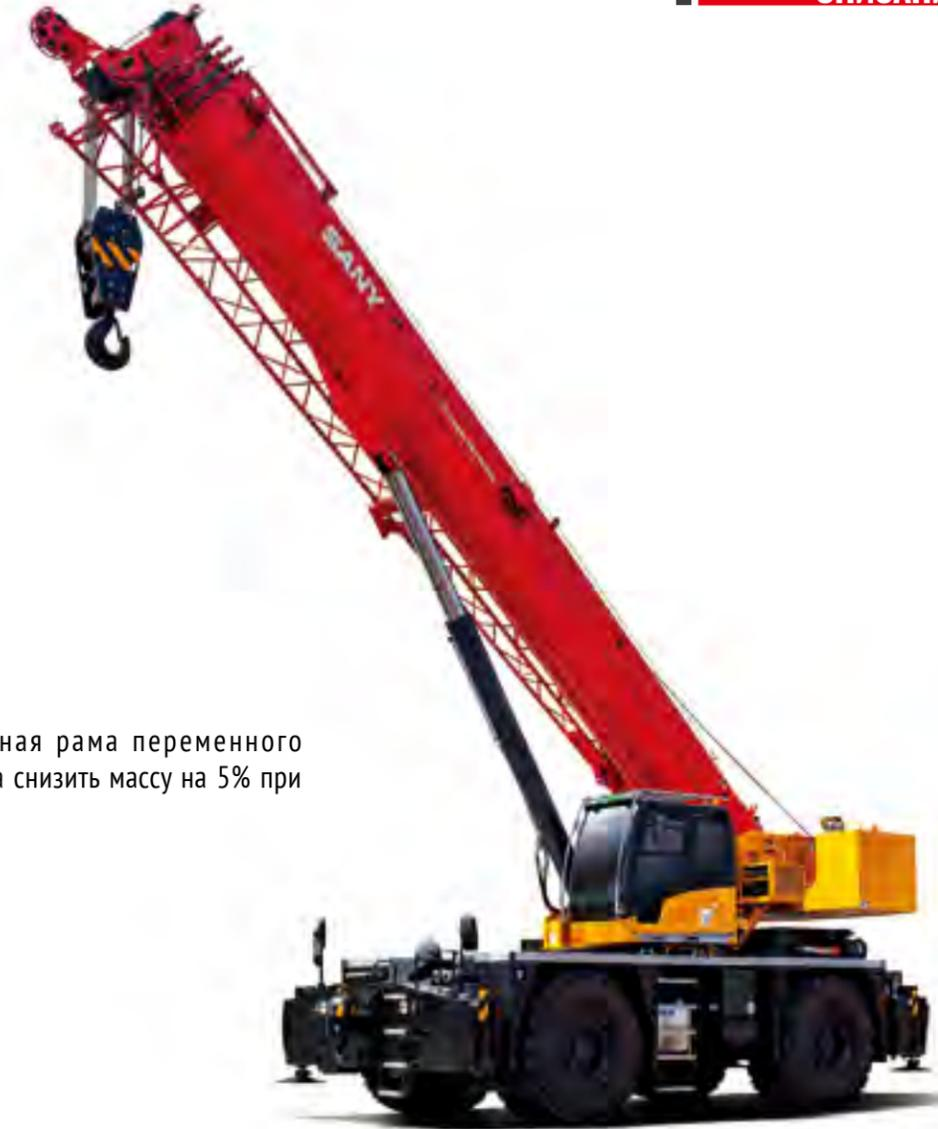
Перевернутая трапецевидная рама переменного поперечного сечения позволила снизить массу на 5% при увеличении жесткости на 10%.
